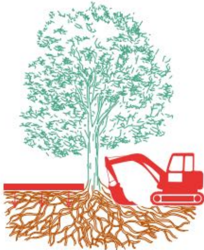
Décapage du sol/remblais
